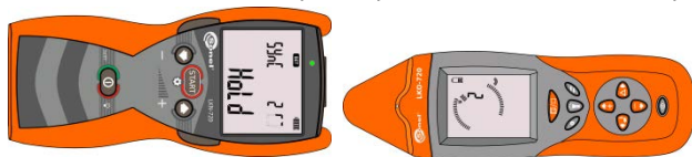
Рис. 5 Положение генератора и приемника во время синхронизации
