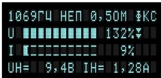
Рисунок 6.1 – режим ограничения по напряжению (▼)
