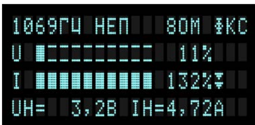
Рисунок 6.3 – режим ограничения по току (▼)
