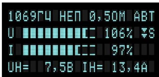
Рисунок 6.2 – режим ограничения по мощности (▼S)
