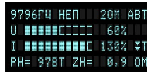
Рисунок 6.4 – режим ограничения по температуре (▼T)
