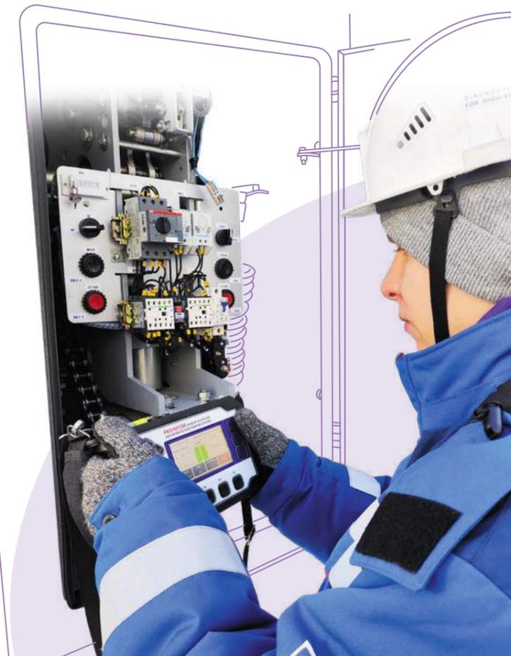
**ОБЛАСТЬ ПРИМЕНЕНИЯ:** прибор предназначен для диагностики элегазовых, масляных, электромагнитных и вакуумных высоковольтных выключателей.
