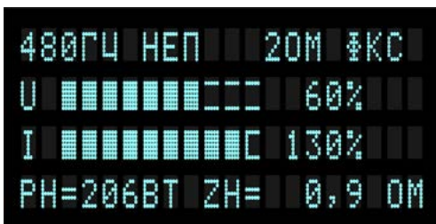
Рисунок 8 – Переход к ручному согласованию
