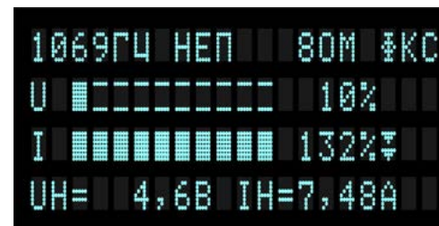
Рисунок 6.3 – режим ограничения по току (▼)
