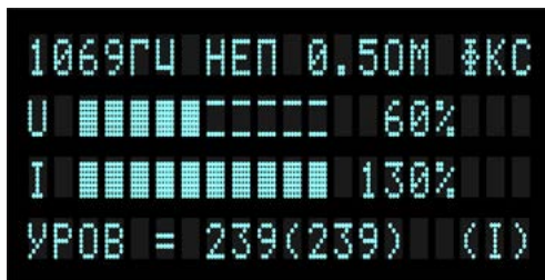
Рисунок 12 – Стабилизация по току
