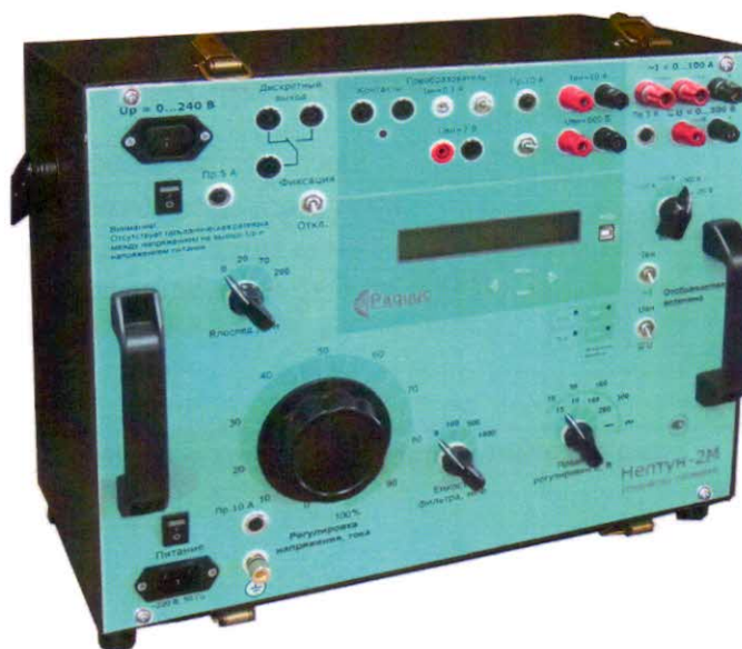
Рисунок 1 - Общий вид устройства проверки простых защит «Нептун-2М»
