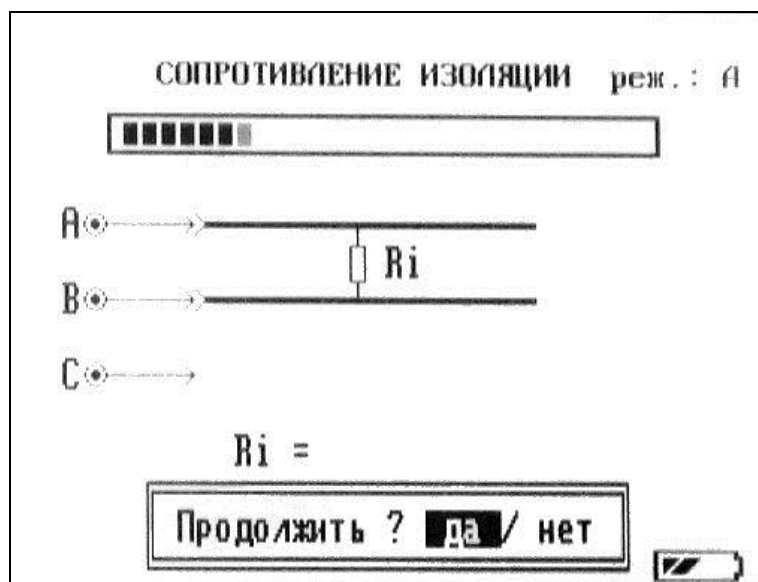
Рисунок 6-13 Измерение сопротивления изоляции
