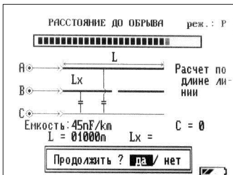
Рисунок 6-18 Определение расстояния до обрыва
