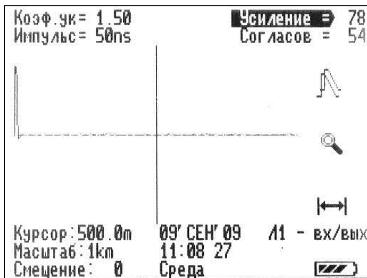
Рисунок 4-3 Вид дисплея в режиме ИЗМЕРЕНИЕ рефлектометра
