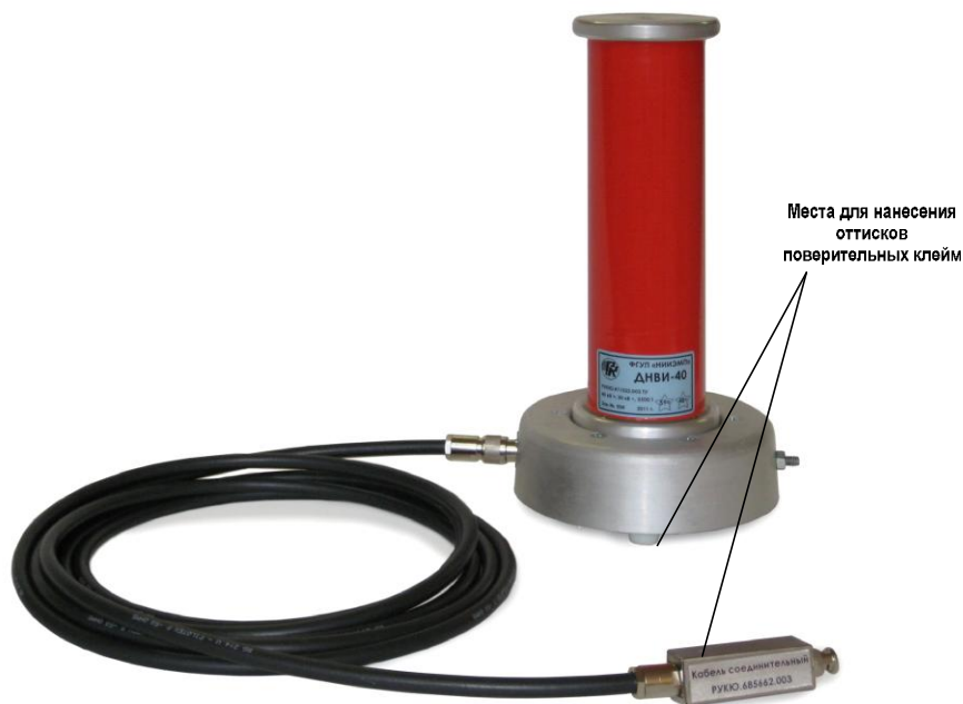
Рисунок 1 - Общий вид делителя напряжений, схема пломбировки от несанкционированного доступа, обозначение места нанесения знака поверки
