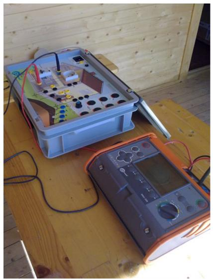
Добавление функции измерения сопротивления присоединения проводников (металлосвязь) наверняка порадует пользователей, т.к. максимальное разрешение теперь в данном режиме будет 0,001 Ом.
