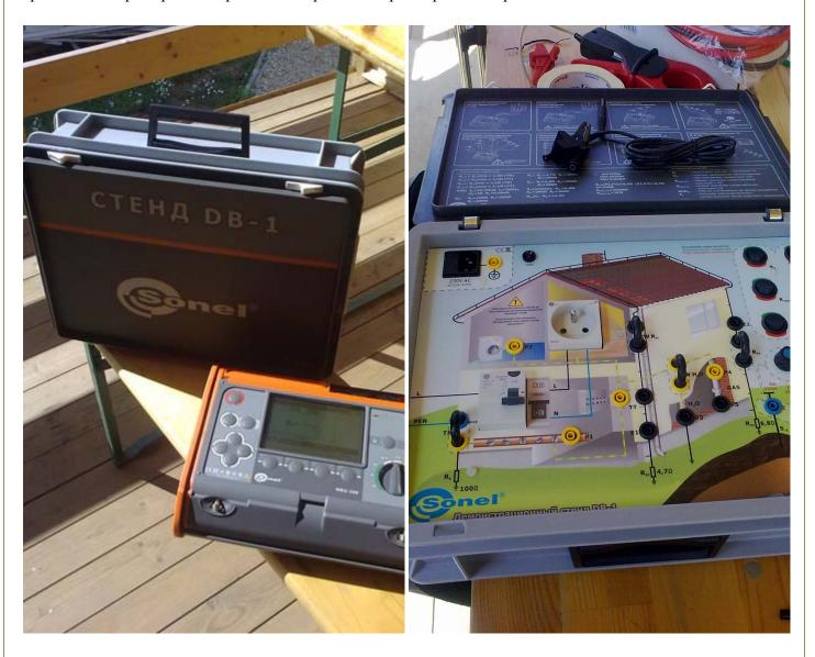
На стенде удалось прогнать все заявленные функции измерителя, кроме измерения силы тока утечки, напряжения и частоты помех.
