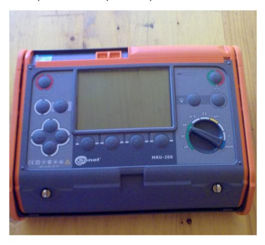
• и когда все варианты будут испробованы, можно пойти на беспрецедентный шаг. Просто отстегнуть крышку от корпуса прибора. Тем самым вес и габариты прибора слегка уменьшаются. Сделать это достаточно легко, благо конструкция крышки и материал пластика изготовлены с учетом данной процедуры.
