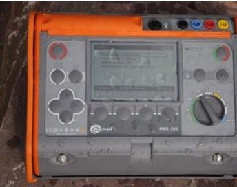
На фронтальной части присутствует оранжевая защелка крышки прибора, и два металлических крепления для ручки переноски измерителя. Данная ручка теперь не является обязательным элементом корпуса, а являет собой полосу специального тканевого материала.
