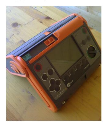
• крышка фиксируется под углом 90 градусов к нижней части прибора. На крепления корпуса надевается ремни «свободные руки» и прибор крышкой упирается в переднюю часть туловища. Такое положение гарантированно предоставляет фиксированное положение дисплея и органов управления на горизонтальном уровне перед лицом.
