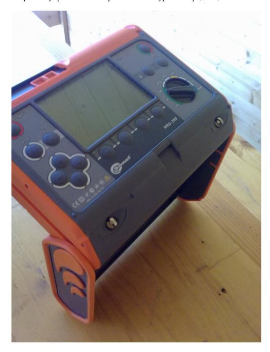
• крышка фиксируется под тыльную часть прибора. Полет фантазии на тему вариантов практического применения данного режима неограничен.
