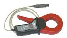
• Клещи передающие **N-1**. Совместно с клещами **C-3** позволяют провести измерение сопротивления методом двух клещей, то есть полностью бесконтактно.
