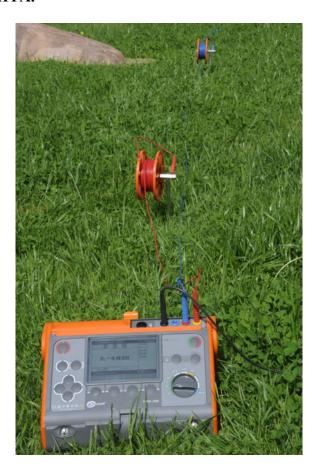
Позволил себе объединить данные типа измерения, т.к. ничего принципиально нового в данных режимах реализовано не было. Все также просто и привычно разматываем катушки с проводами из стандартной комплектации, «цепляемся» крокодилом или струбциной за ГЗШ и нажимаем START на панели прибора.
