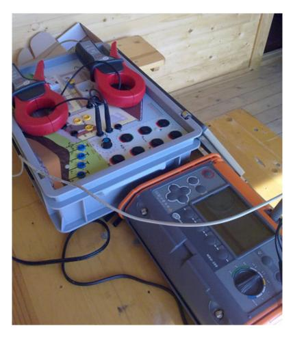
Процесс измерений занимает от 6 до 8 секунд, и в течение всего этого времени на дисплее отображается строка состояния, которая постепенно заполняется от нуля до 100%. С ее помощью достаточно легко визуально отследить оставшееся время до завершения измерения. Допущенные ошибки при сборке схем, были легко идентифицированы прибором, с выдачей подсказок о возможных местах проблем.
