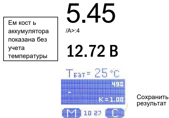
Рис. 3. Дисплей прибора в режиме записи результата по команде.
