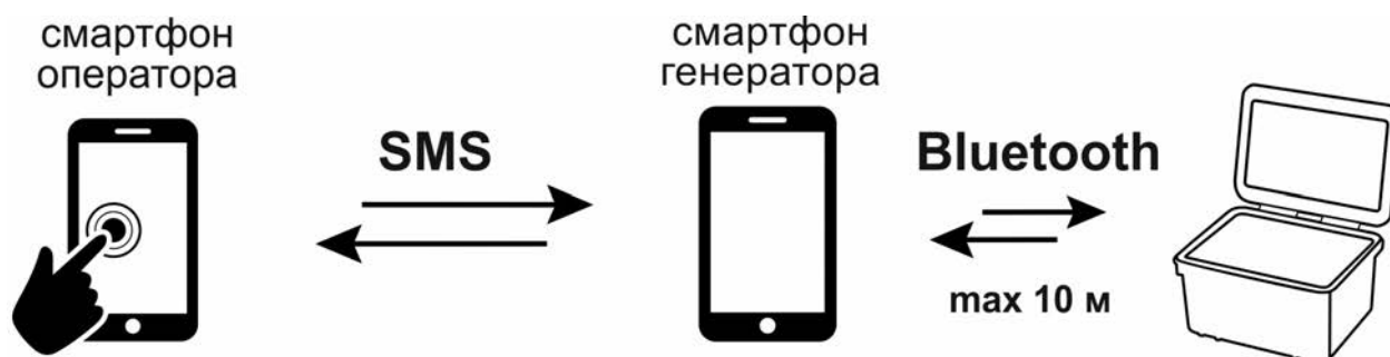
Рисунок 2.8 – Организация дистанционного управления генератором
