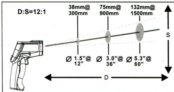
2. Поле обзора: Убедитесь, что исследуемый объект больше, чем размер пятна. Чем меньше объект, тем ближе к нему следует располагать прибор. Когда важна точность, необходимо располагать прибор таким образом, чтобы размер исследуемого предмета минимум в два раза превышал размер пятна.
