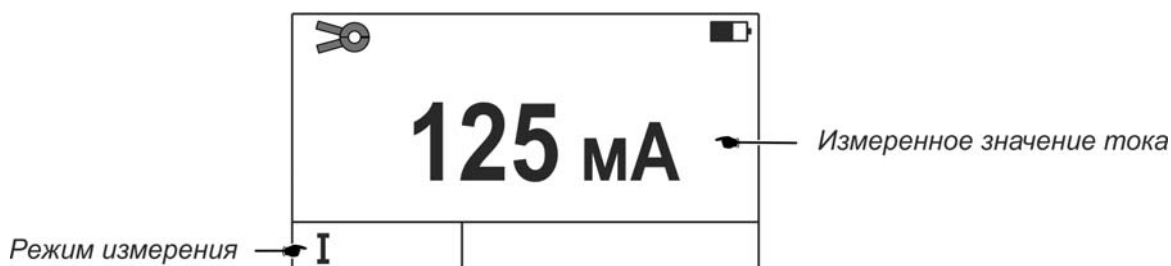
Рисунок 2.13 - Вид индикатора при измерении переменного тока
