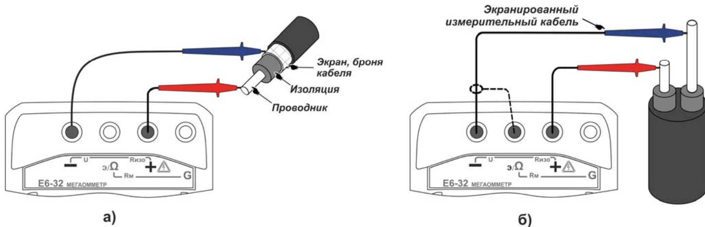
Рисунок 2.5 – Измерение сопротивления изоляции кабеля
