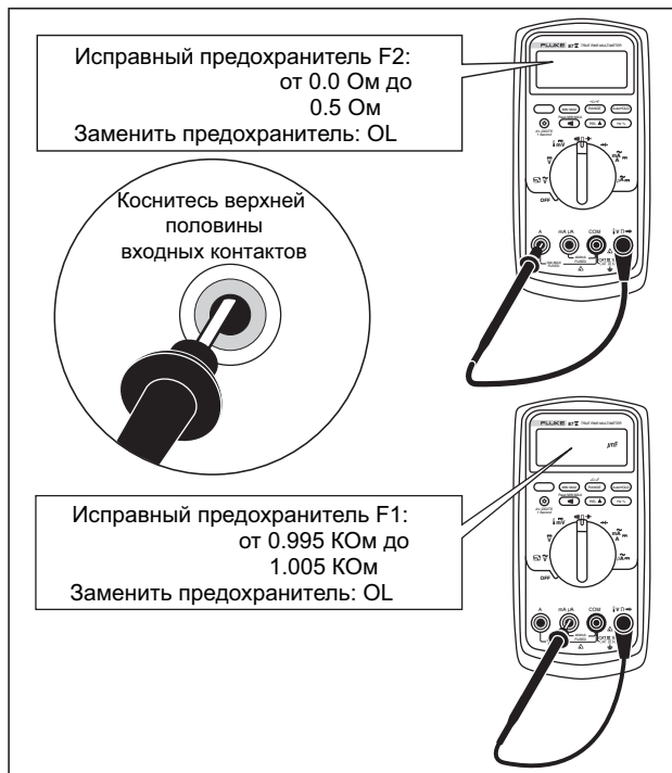
Рисунок 10. Контроль предохранителей тока
